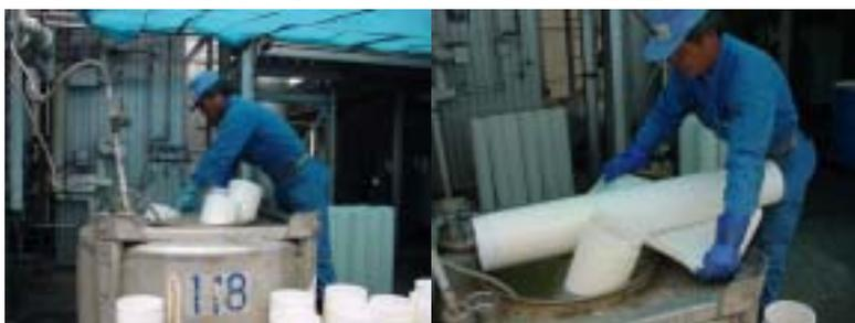
・ウレタン付 HIPS( )コア(フィルムの巻芯)には、フィルム保護のためウレタンが巻かれていたため、これまで複合材として廃棄していたが、お湯に浸すことによりウレタンを剥がすことが可能になり、その結果、ウレタンは樹脂として再利用し、コアはリユースが可能になった。なお、このお湯は焼却炉から回収した蒸気を利用している。
