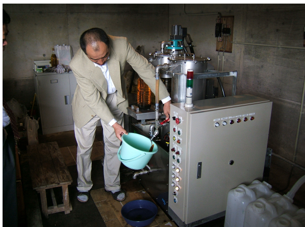
PDF製造装置。園児から家庭で使用した廃食用油を持ってきてもらい、BDFを作り送迎バスに利用。
